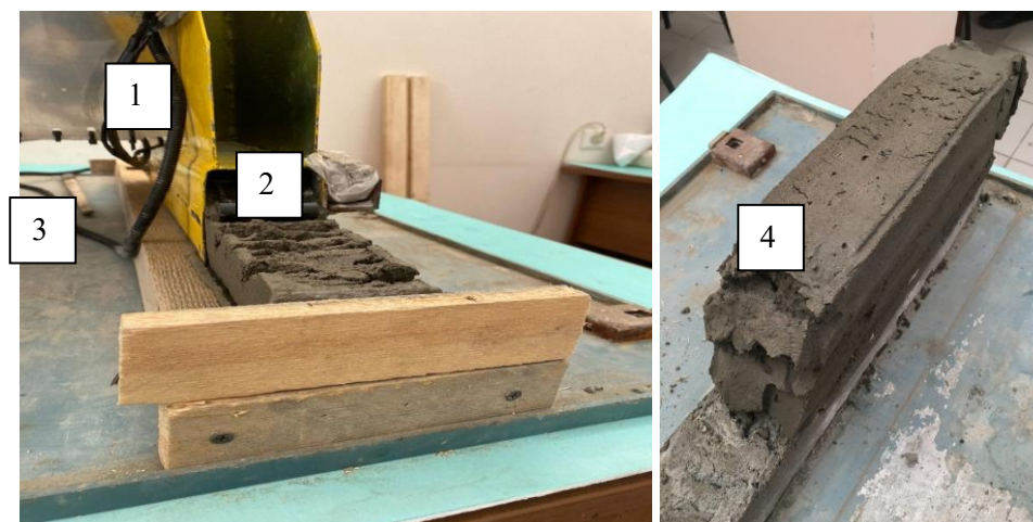
Рисунок 1. Виброэкструзионная модель 3D-принтера (Разработал автор Шулюшенков Д.С.)
