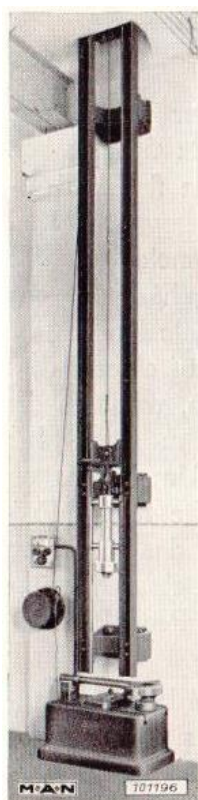
Abb. 12. Fallwerk für 50 kg größtes Bärge- wicht und 3 m Fallhöhe.
