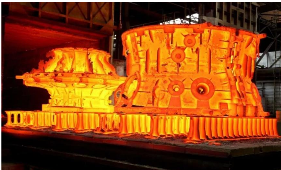
Рисунок 9. Термическая обработка крупных металлических конструкций (источник: https://metallo-obrabotka24.ru )
