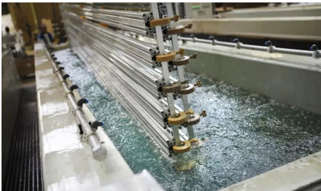
Рисунок 7. Фосфатирование металлоконструкций в специальной ванне с раствором (источник: https://al5holding.com/ )
