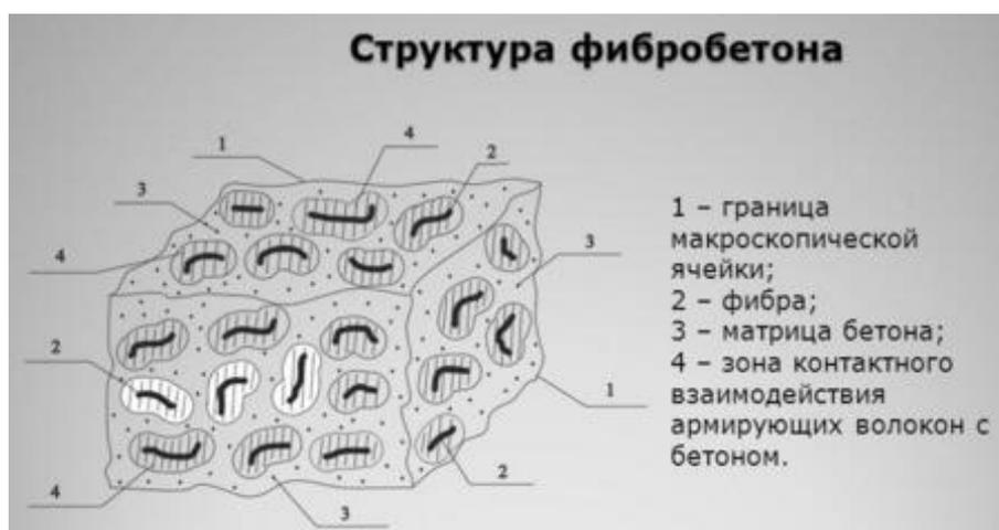
Рисунок 3. Структура фибробетона <https://kladembeton.ru/vidy/drugie/fibrobeton.html>
