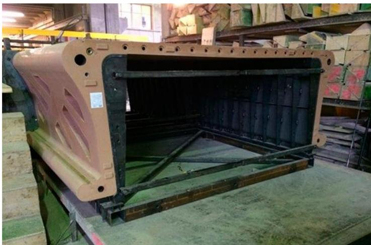
**Рисунок 6.** Блок пешеходного перехода через железнодорожные пути в Le Cannet-des-Maures (Франция) <https://lafargeholcimrus.ru/advises/article/o-primenenii-sverkhvysokoprochnogo-fibrobetona-ductal-v-rossiyskom-mostostroenii/>
