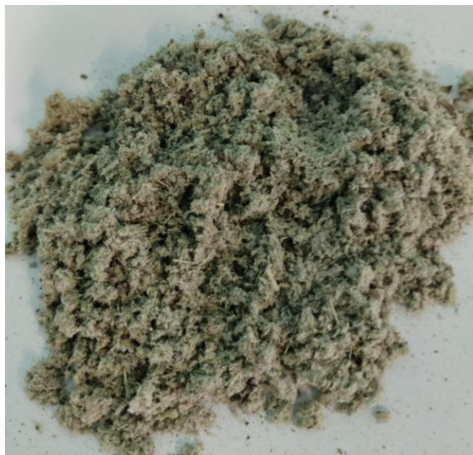
Рисунок 1. Волокно хризотил-асбеста полученное после промывки щебня (фото авторов)
