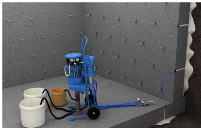
Рисунок 2. Устройство инъекционной гидроизоляции
