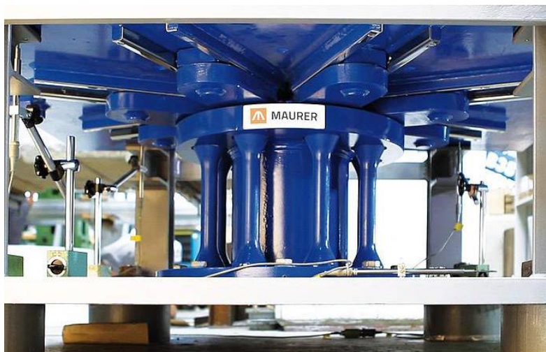
Рисунок 20. Стальной демпфер MRSD с центрированием в двух направлениях (источник: https://www.maurer.eu/de/produkte/dehnfugen/dehnfugen-fuer-strassenbruecken/index.html )
