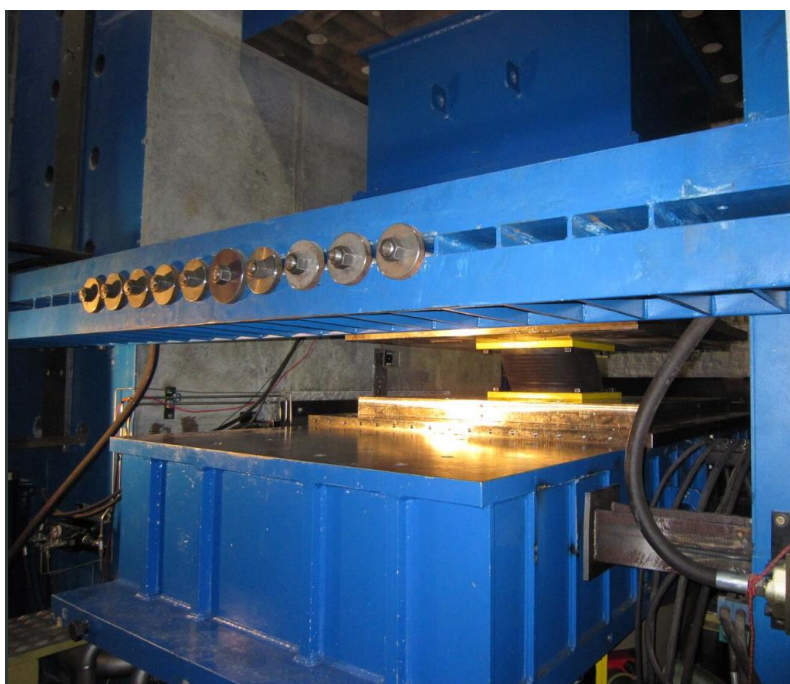
Рисунок 16. Испытание опорной части LASTO@LRB со свинцовым сердечником (источник: https://www.mageba-group.com/ru/ru/1026/Buildings/Seismic-devices/LASTO-HDRB/Detail.htm )
