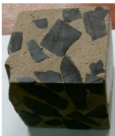
Рисунок 2. Образец дорожного основания, укрепленного СВПС (составлено авторами)
