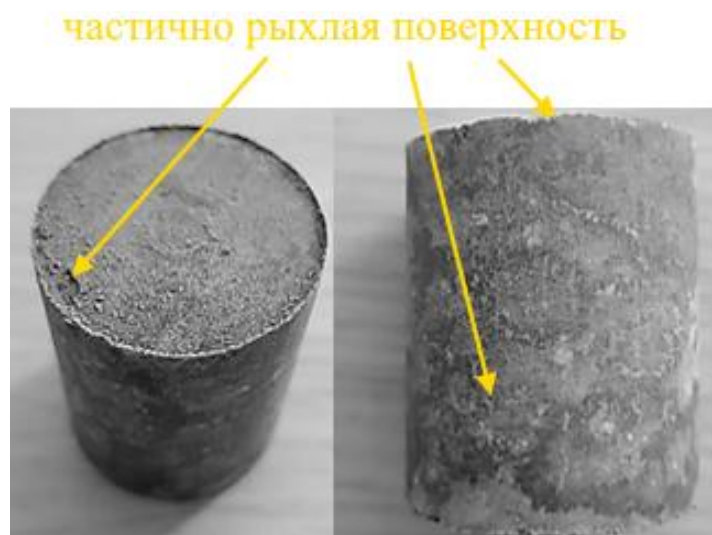
Рисунок 3. Образцы геополимеров в возрасте 28 суток, уплотненных штыкованием (создано авторами)
