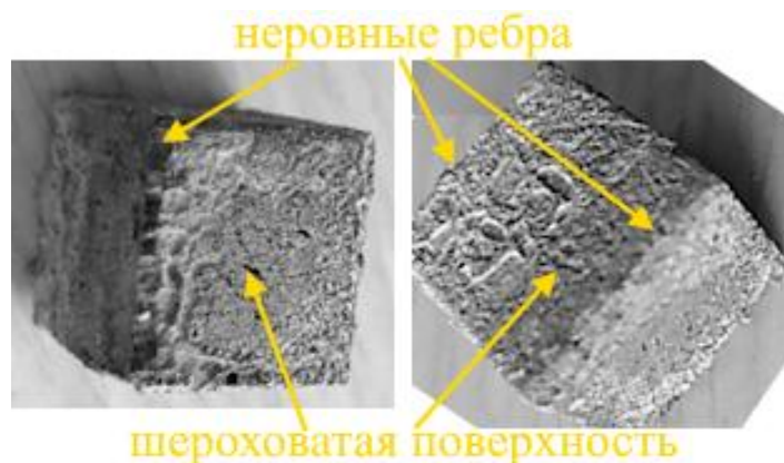
Рисунок 2. Образцы геополимеров в возрасте 28 суток, уплотненных прессованием (создано авторами)
