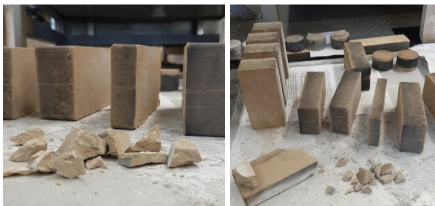
Рисунок 4. Затвердевшие образцы в возрасте 28 суток и их внутреннее строение (вибрационное уплотнение) (создано авторами)
