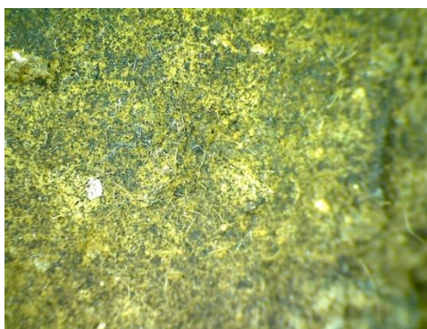
Рисунок 5. Фото поверхности сформированного слоя из смеси сухого дробленого песка фр. 0–3 мм, перемешанного с битумной суспензией, армированной фиброй (рисунок авторов)
