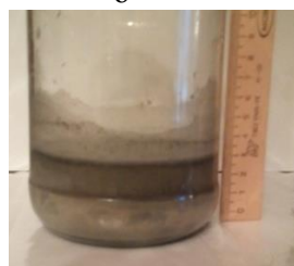
2 ложки суспензии, легко получается однородная смесь, быстро расслаивается
