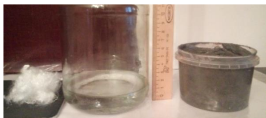
фибра 3 см 3 вода 0,2 л суспензия в пластичном состоянии 0,2 л
