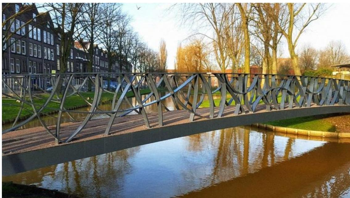
*Рисунок 11. Пешеходный мост на основе пролётного строения из стеклопластика с экспрессивной металлической решёткой перил. Роттердам, Голландия. 2016 г.*
