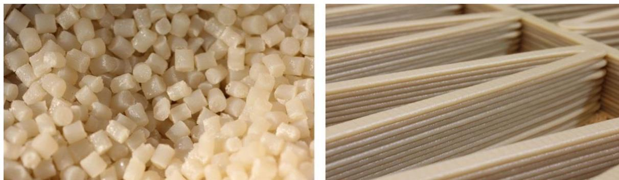
**Рисунок 26.** Акрилонитрил-стирол-акрилат перед разогревом и подачей на печатающее устройство. Готовые слои материала
