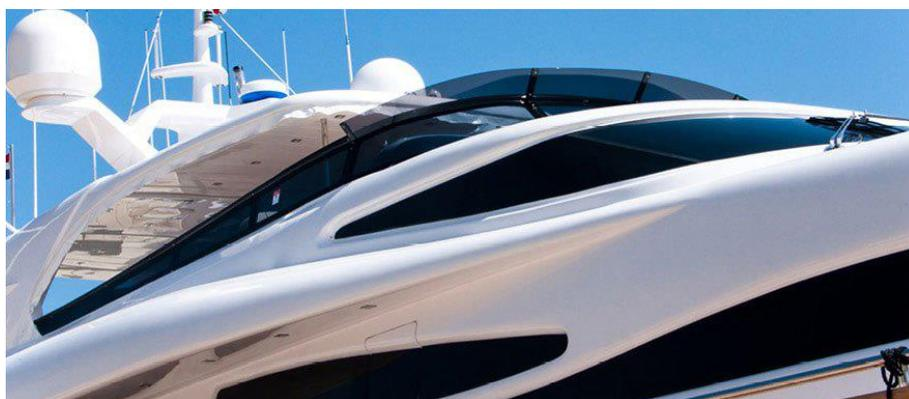
**Рисунок 14.** Фрагмент стеклопластикового корпуса яхты. Германия
