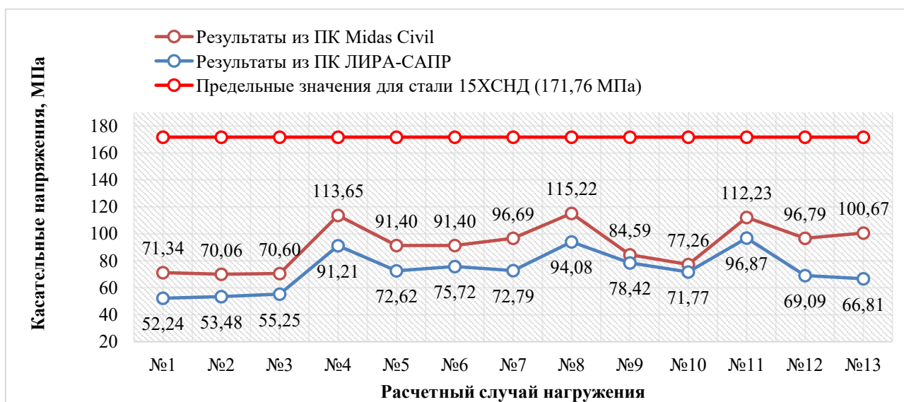
Рисунок 15. График распределения эквивалентных касательных напряжений в главных балках согласно третьей энергетической теории наибольших касательных напряжений (Напряжения по Треска) для расчетного случая № 8 (составлен авторами)
