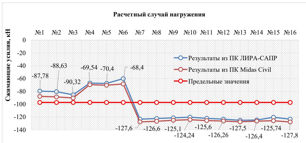
Рисунок 19. График распределения сжимающих усилий в верхней распорке промежуточных связей в зависимости от расчетного случая (составлен авторами)
