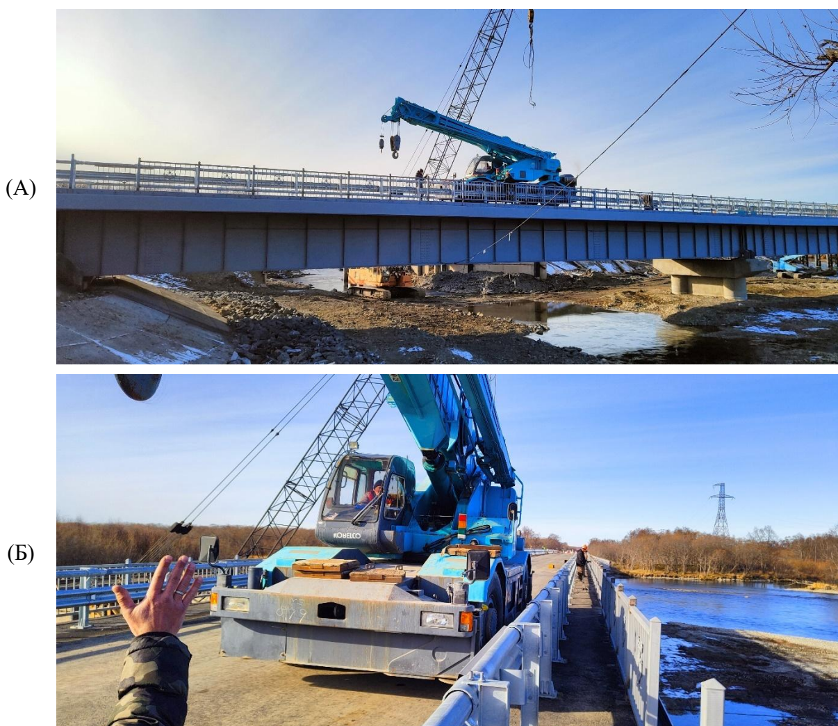
Рисунок 33. Размещение испытательной нагрузки на пролетном строении: (А) общий вид размещения испытательной нагрузки с фасада моста; (Б) размещение испытательной нагрузки с мостового полотна (третья схема) (фото автора)
