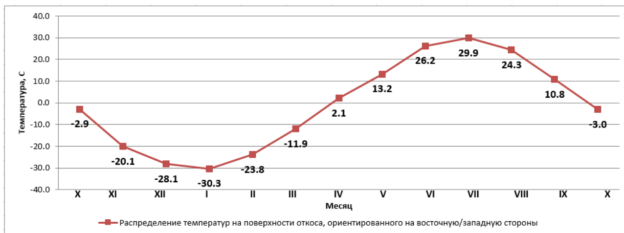
Рисунок 3.4. График средних значений температур откосов насыпи, ориентированных на восточную и западную стороны (разработано автором)
