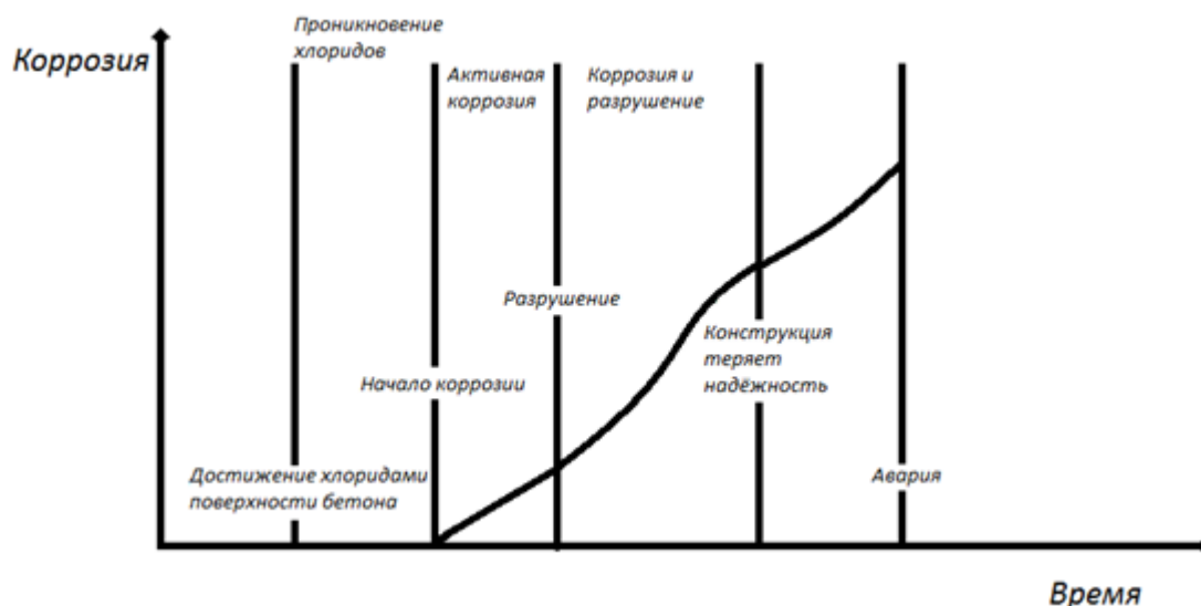
Рисунок 6. Разрушение железобетона вследствие хлоридной коррозии
