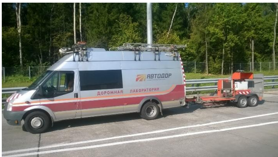
Рисунок 1. Установка динамического нагружения FWD (источник: http://avtodor-eng.ru/cntnt/novosti-1/n341.html )
