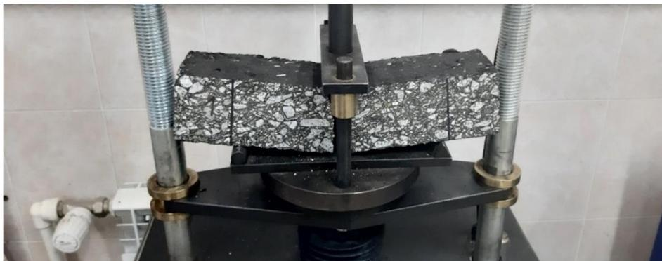
*Рисунок 7. Проведение испытаний на изгиб при температуре (минус  $18\pm 2^\circ\text{C}$ ) (разработано автором)*
