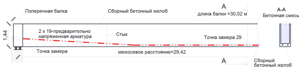
Рисунок 20. Продольный разрез испытываемой балки [18]
