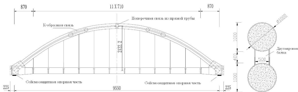
Рисунок 10. Конструкция Второго моста через реку Хуанхэ в Чжэнчжоу. Размеры на фасаде указаны в см, на сечении — в мм [8]
