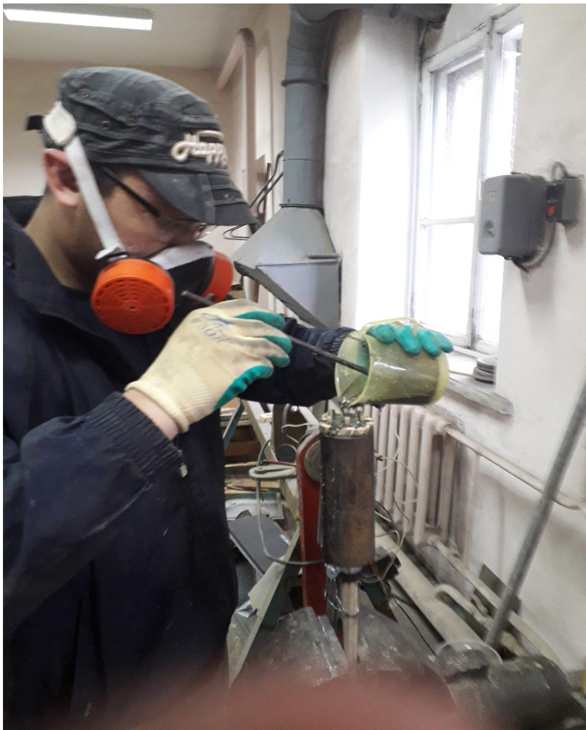
Рисунок 13. Фотография, сделанная в момент непосредственной «заливки» компаундом анкера (разработано авторами)
