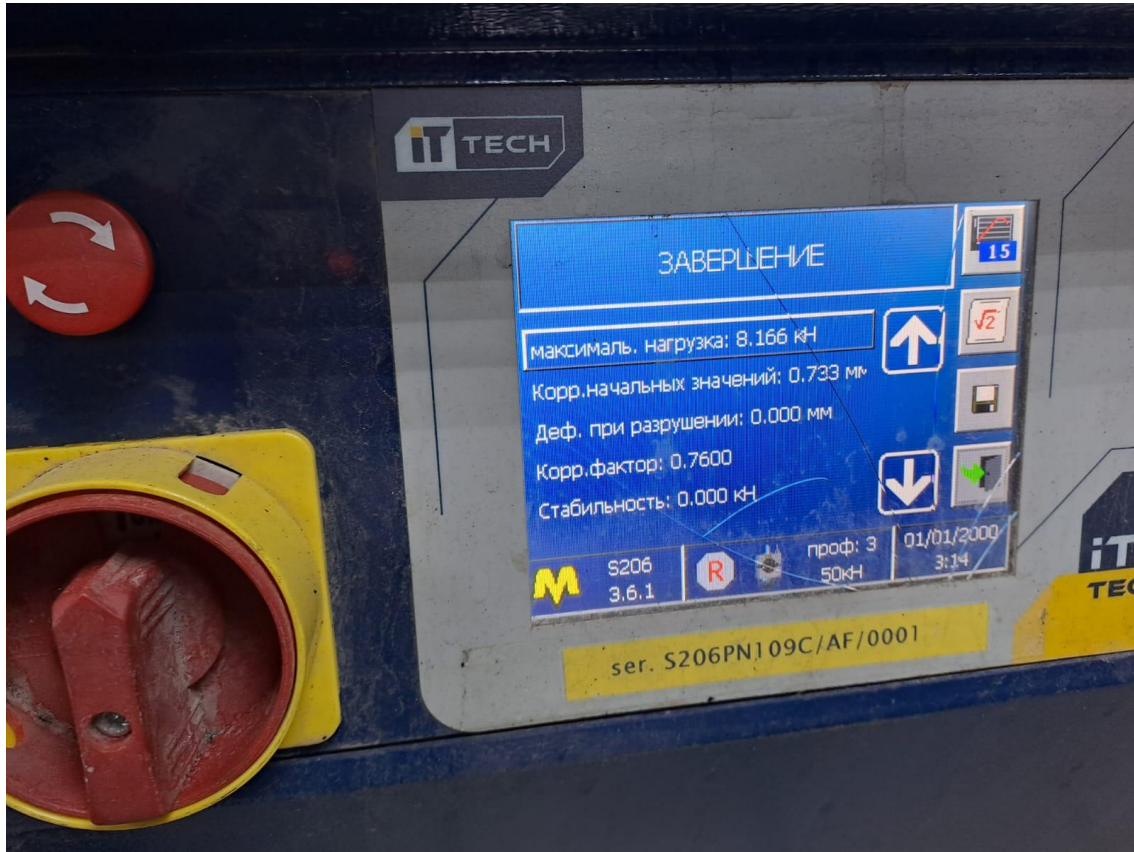
Рисунок 6. Показания прибора Лейтнера образца № 2.3 (изображение предоставлено автором)
