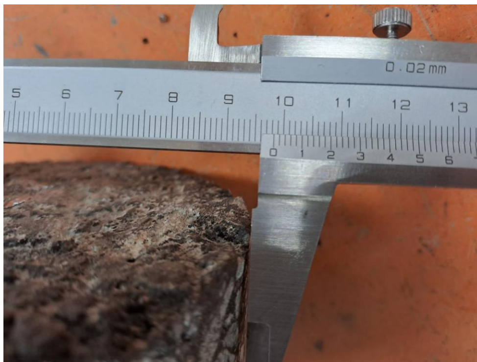
Рисунок 3. Замер диаметра испытуемого образца № 1 в верхней трети вырубки (керна) (изображение предоставлено автором)
