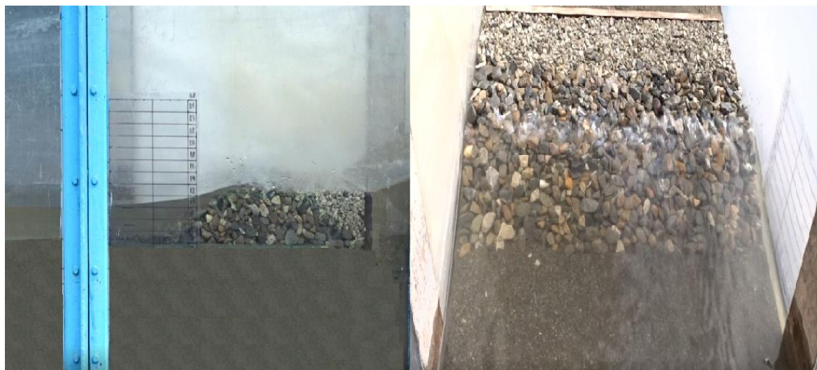
Рисунок 12. Воздействие волнения на модель бермы из камня для защиты земляного полотна ДВЖД в волновом лотке (фото автора)
