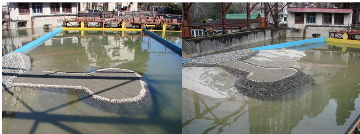
Рисунок 8. Модель технологической площадки моста в волновом бассейне в масштабе 1:52 (фото автора)
