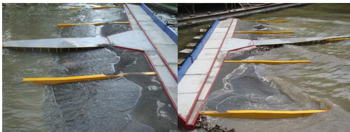
Рисунок 11. Воздействие волнения на модель берегозащитных сооружений земляного полотна в районе ж.д. станции Адлер в волновом бассейне в масштабе 1:35 (фото автора)
