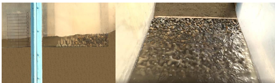
Рисунок 13. Воздействие волнения на модель бермы из камня и тетраподов для защиты земляного полотна ДВЖД в волновом лотке (фото автора)
