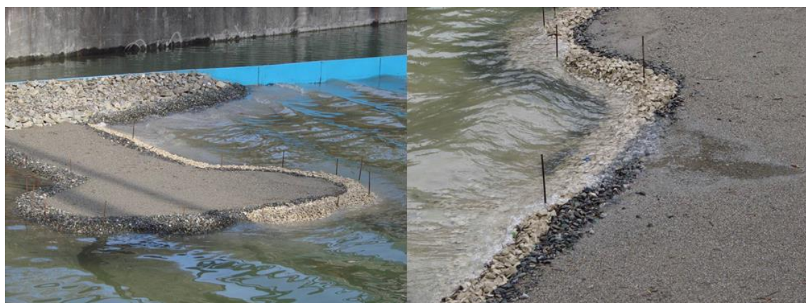
Рисунок 9. Воздействие волнения на модель технологической площадки моста в волновом бассейне в масштабе 1:52 (фото автора)
