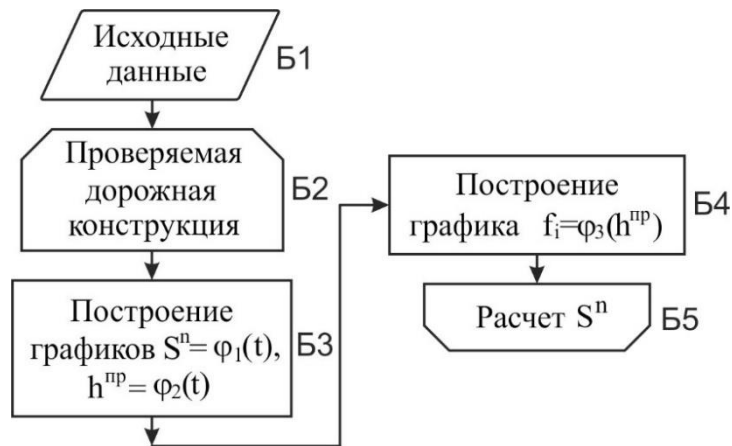
Рисунок 4. Блок-схема к определению расчетной деформации дорожной конструкции (составлено/разработано автором)
