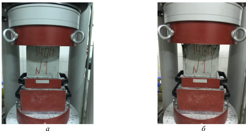
Рисунок 1. Общий вид проведения испытаний: а – образец до проведения испытаний; б – образец после проведения испытаний (составлено авторами)
