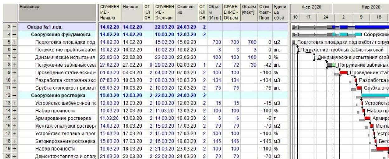
Рисунок 23. Сравнение версий графиков до и после внесения учета выполненных работ в ПО Spider Project (разработано авторами)
