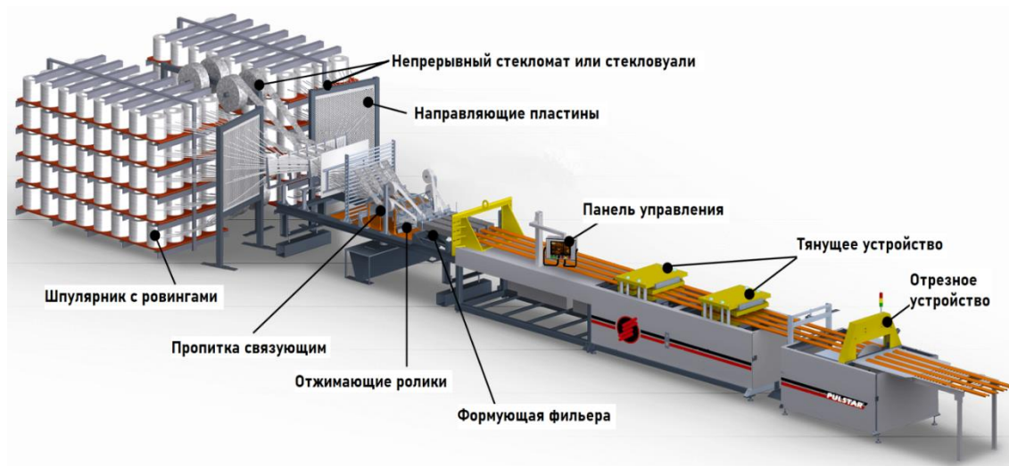
Рисунок 3. Схема изготовления детали из композитного материала методом пултрузии (источник: https://www.strongwell.com/about/the-pultrusion-process/ )
