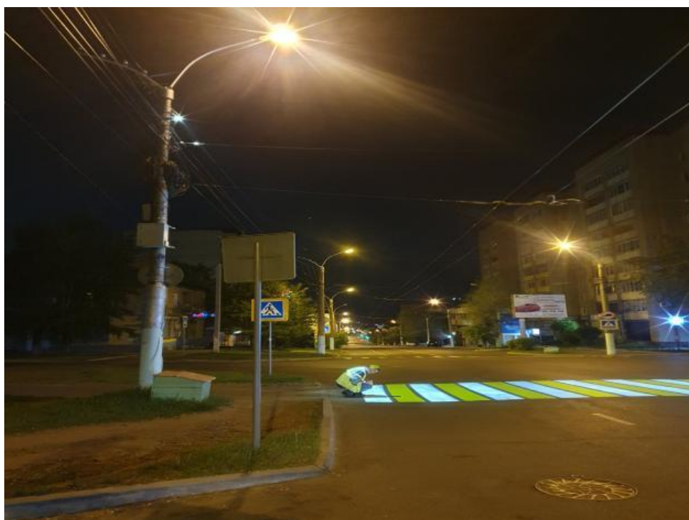
Рисунок 3. Измерение уровня освещения пешеходных переходов, оборудованных прожекторами по улице Бутина и ул. Ленинградская г. Чита (фото автора)
