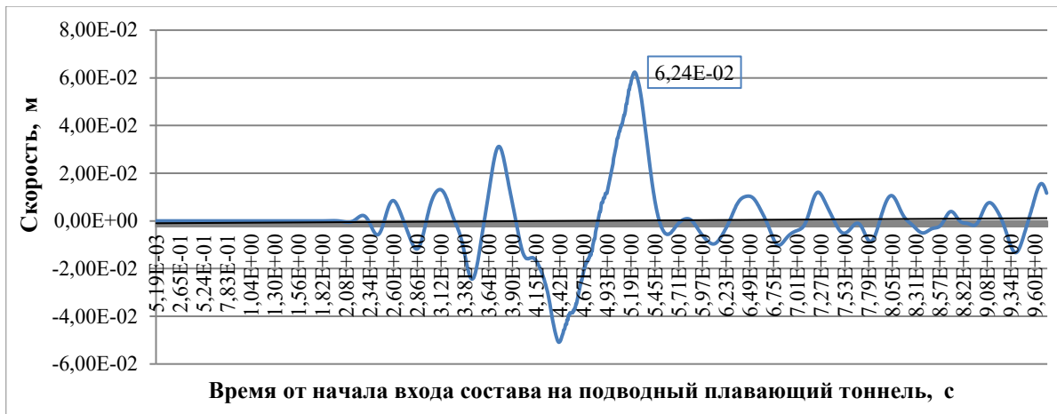
Рисунок 24. Вертикальная скорость перемещения узла № 41 с учетом вязкости воды (разработано авторами)
