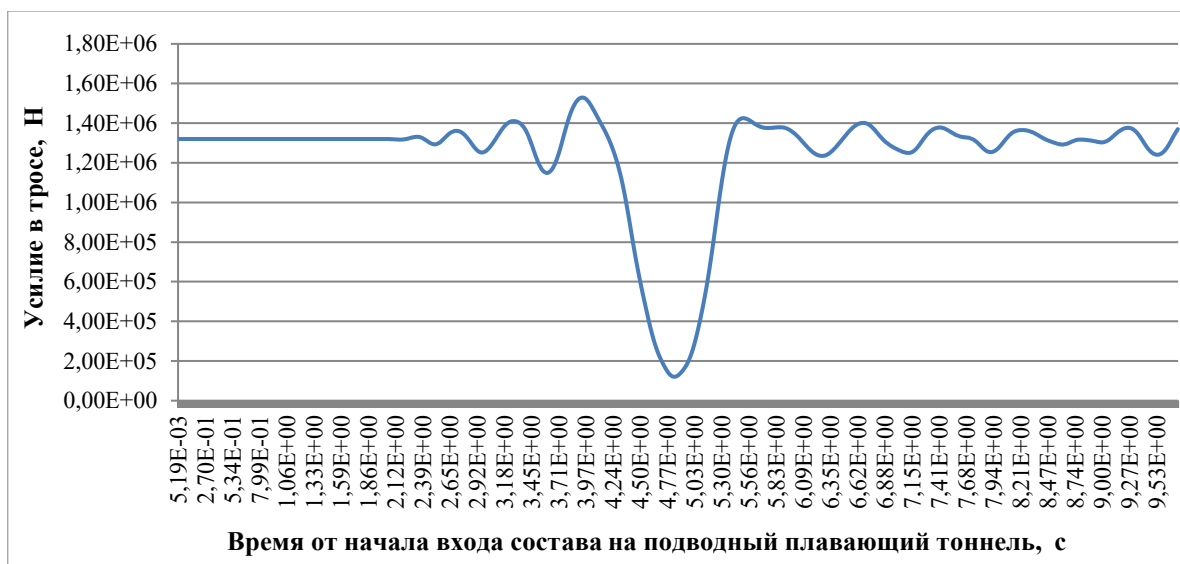
Рисунок 20. Диаграмма усилия в среднем тросе № 41 при сумме постоянных нагрузок 44 кН/м. Скорость поезда 1 000 км/ч (разработано авторами)
