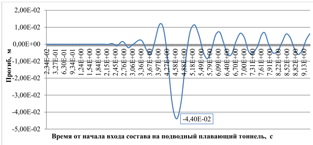
Рисунок 3. Диаграмма перемещений середины балки жесткости сооружения при отсутствии вязкого сопротивления среды (разработано авторами)
