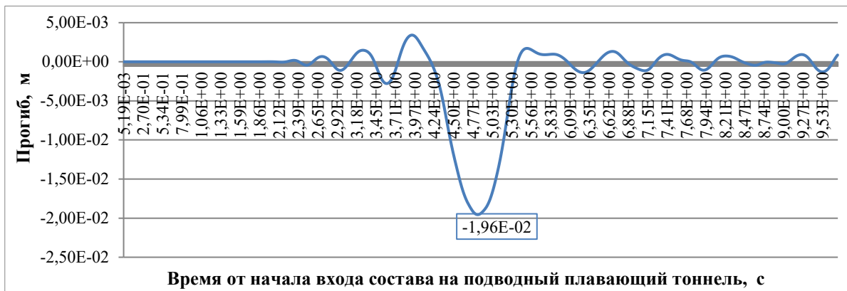
Рисунок 22. Деформации середины балки жесткости при учете вязкости воды (разработано авторами)
