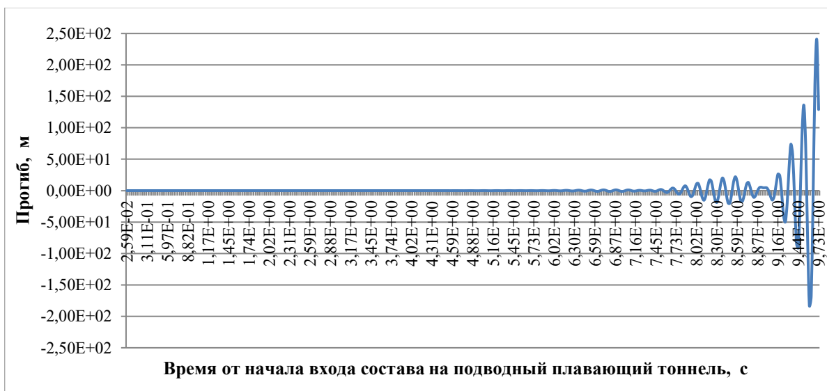
Рисунок 4. Диаграмма колебаний середины балки жесткости сооружения при скорости сверхскоростного состава 278 м/с. Демонстрируется неустойчивость численного интегрирования при слишком большом шаге интегрирования \Delta t (разработано авторами)
