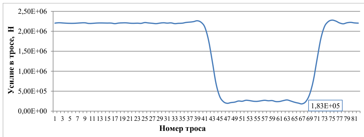
Рисунок 5. Эпюра усилий в тросах в момент t = 76,5 с без учета сопротивления воды. Состав из 60 вагонов между узлами 44 и 72 (разработано авторами)
