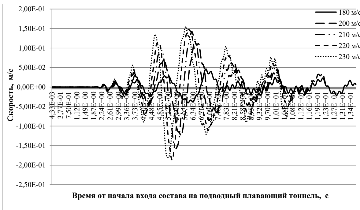
Рисунок 2. Вертикальные скорости середины балки жесткости при различных скоростях движения. Нагрузка в виде сосредоточенной силы (разработано авторами)
