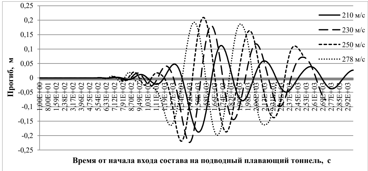
Рисунок 25. Прогибы середины балки жесткости при различных скоростях движения сверхскоростного поезда (разработано авторами)
