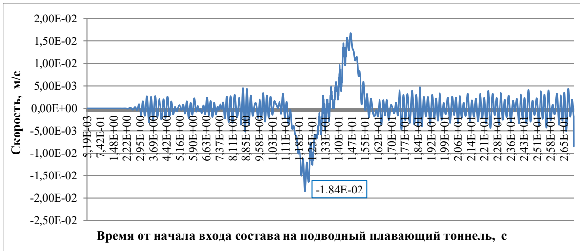
Рисунок 8. Вертикальная скорость перемещения без учета сопротивления воды центрального узла № 41. Скорость движения 100 м/с (360 км/ч) (разработано авторами)
