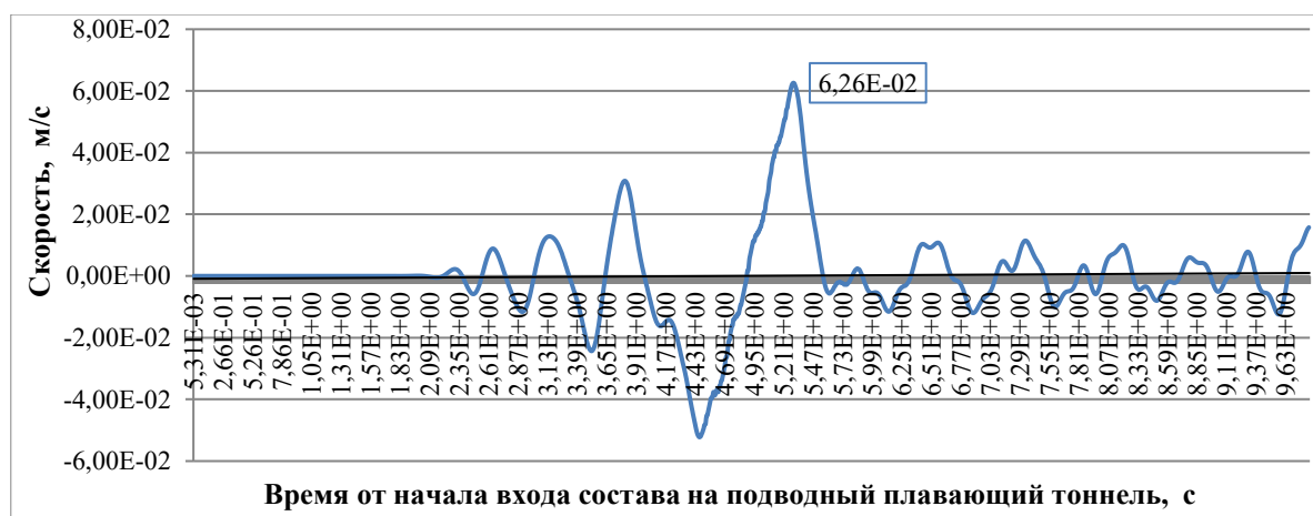
Рисунок 10. Вертикальная скорость перемещения центрального узла № 41 без учета сопротивления воды. Скорость движения 278 м/с (1 000 км/ч) (разработано авторами)
