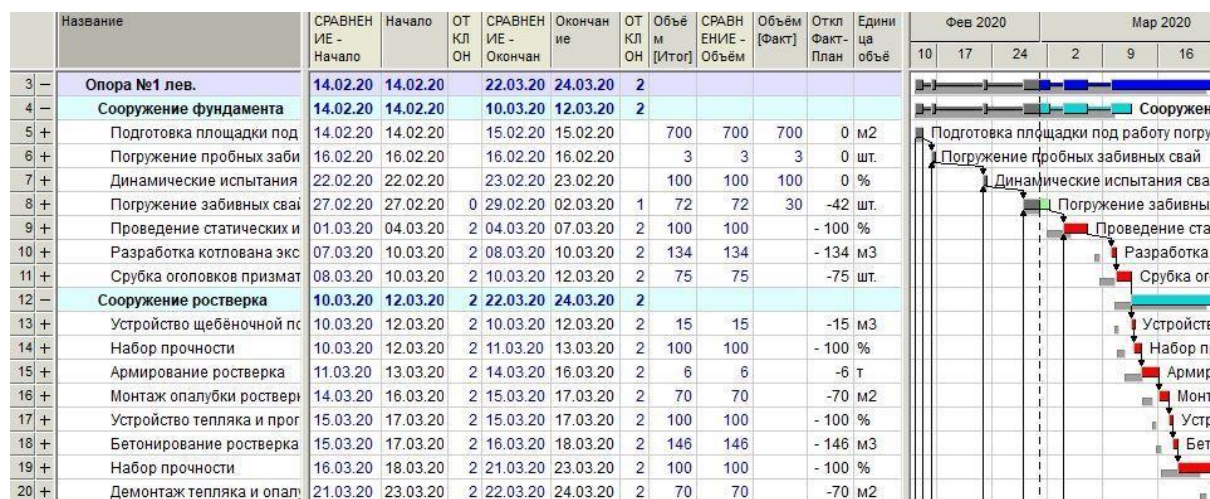
Рисунок 10. Сравнение версий и выявление отклонений проекта после занесения учета проведённых работ в ПО Spider Project [22]
