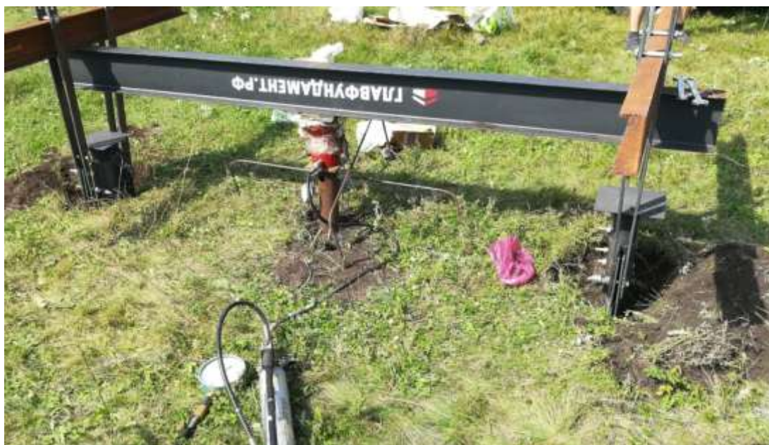
Рисунок 7. Статические испытания винтовой сваи (фото автора)
