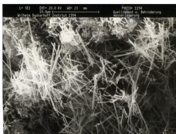
Рисунок 1. Размещение тонких кристаллов этtringита с соотношением длина/диаметр 14–20 в поровом пространстве цементного камня (разработано авторами)
