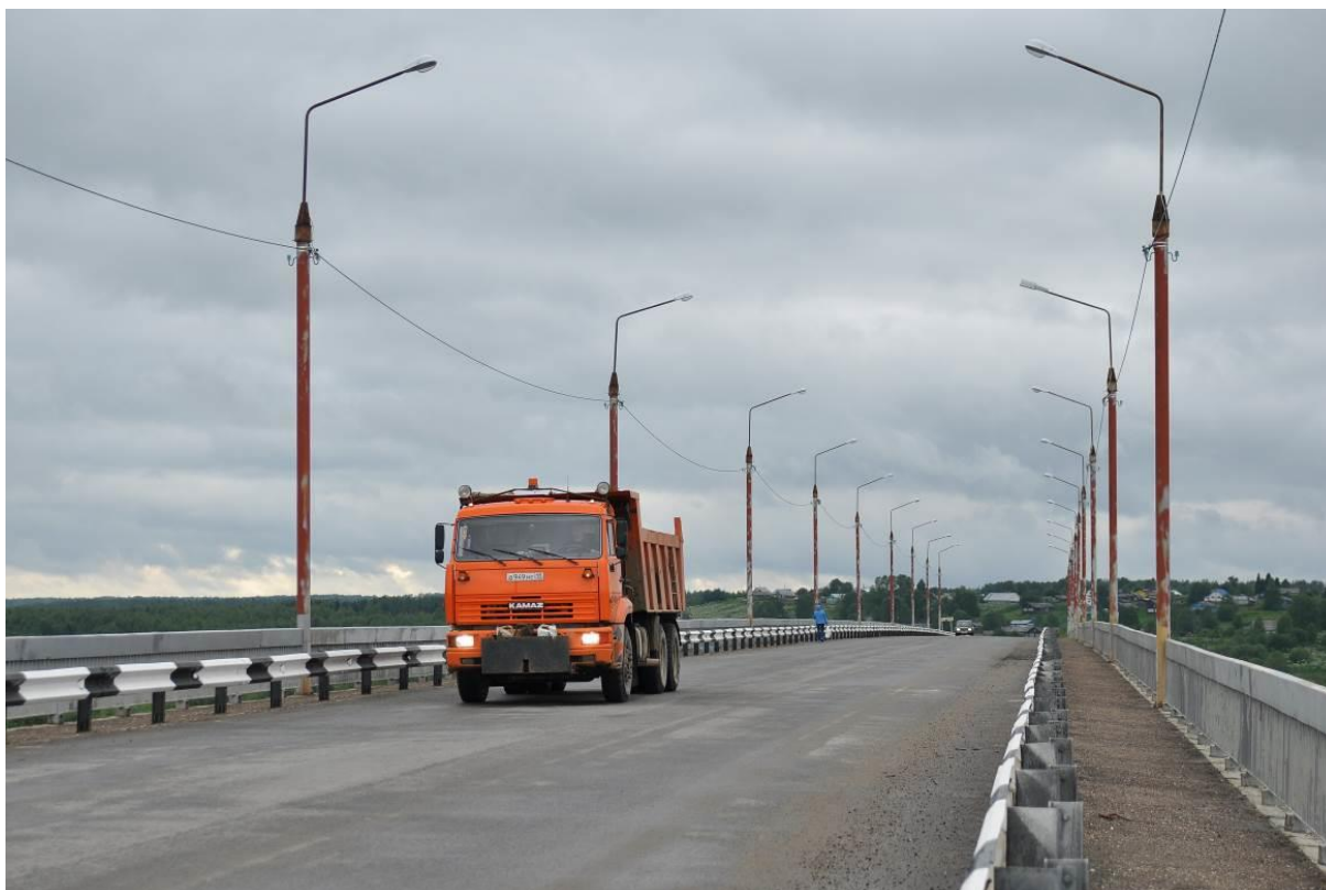
Рисунок 4. Проезд автомобиля при динамических испытаниях моста (выполнено авторами при проведении натурных динамических испытаний)
