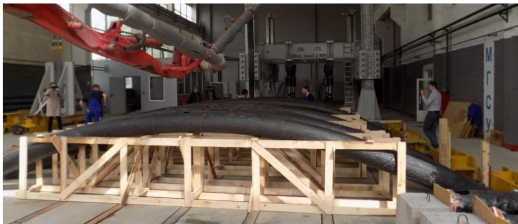
Рисунок 14. Испытание трубчатых арочных элементов в лаборатории [19]
