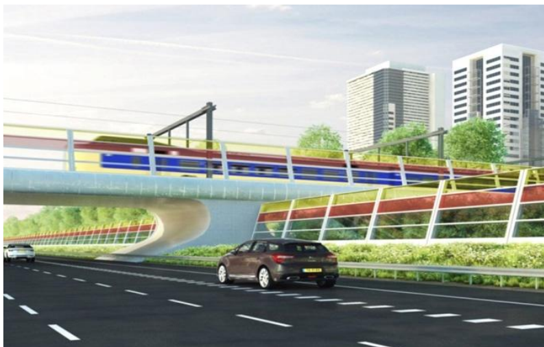
Рисунок 20. Шумозащитные экраны, используемые для получения солнечной энергии [23]
