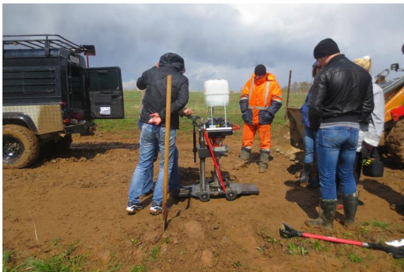
Рисунок 4. Взятие проб из слоев основания кернаотборником
