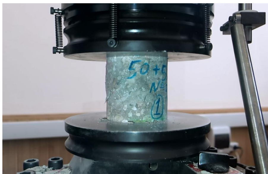
Рисунок 5. Испытание кернов на прессе (фотография авторов)
