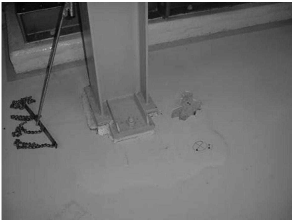
Рисунок 7. Устройство для волочения цепи [12]
