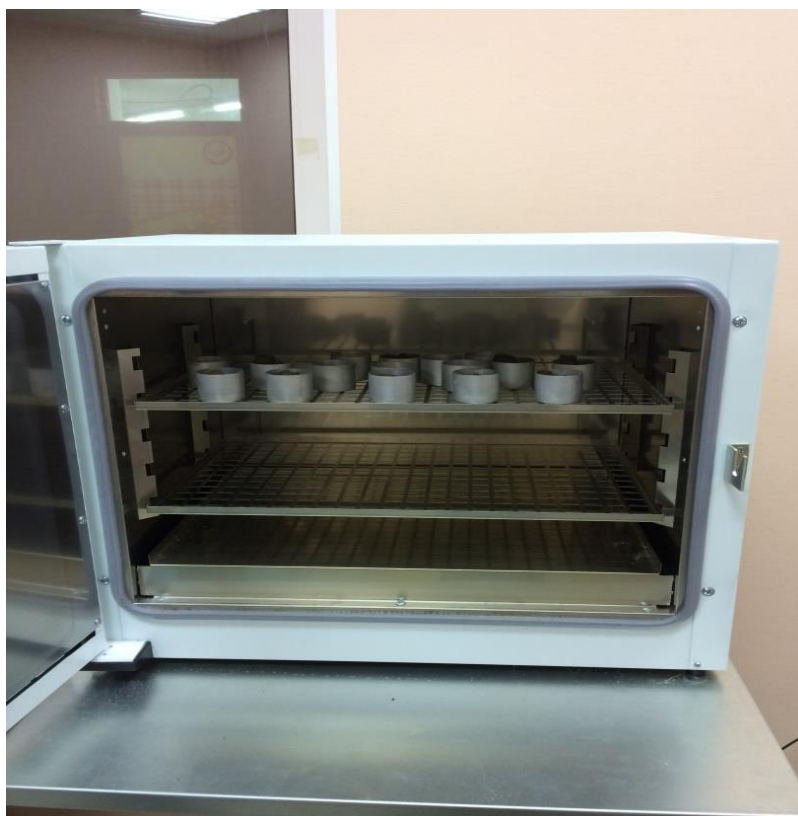
Рисунок 7. Сушильный шкаф с бюксами (фотография выполнена авторами)
