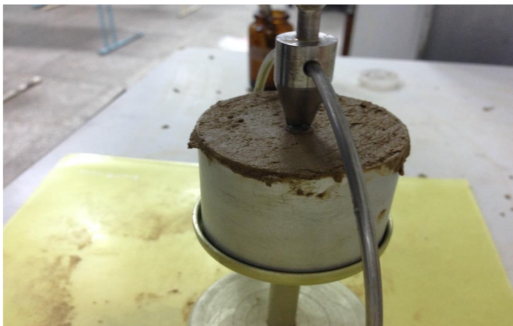
Рисунок 6. Определение границы текучести (фотография выполнена авторами)
