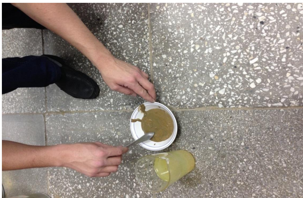
Рисунок 1. Подготовка грунтовой пасты с добавлением гидрофобизатора (фотография выполнена авторами).
