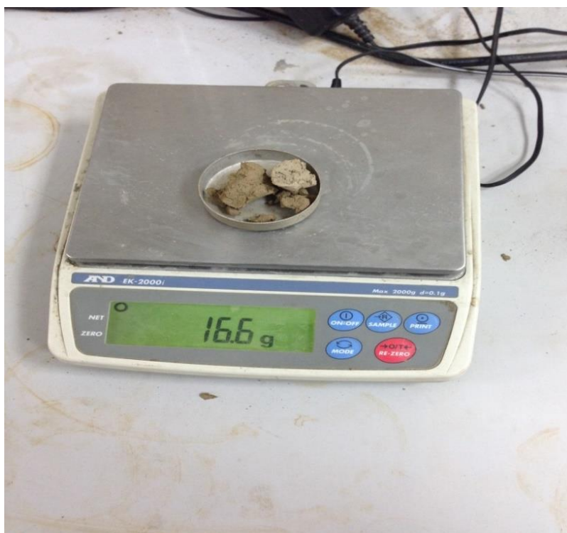
Рисунок 8. Взвешивание бюкса с грунтом (фотография выполнена авторами)
