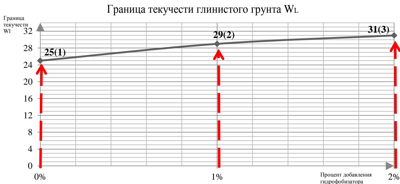
Рисунок 9. Результаты определения границы текучести W_L глинистого грунта в лабораторных условиях (выполнено авторами)
