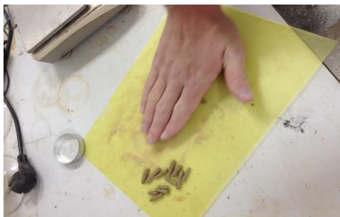
Рисунок 2. Раскатывание глинистого грунта с добавкой гидрофобизатора (фотография выполнена авторами)
