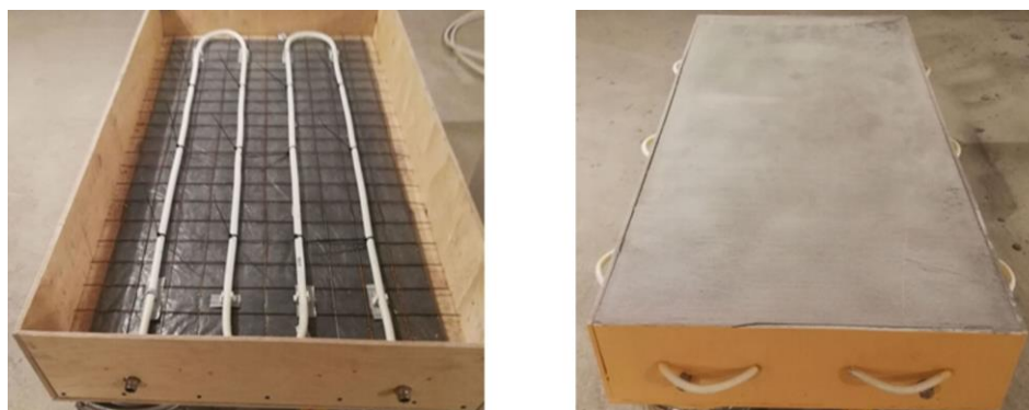
Рисунок 2. Вид экспериментальной модели одежды ездового полотна до и после заливки пескобетоном (фотография авторов)
