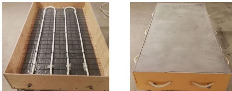
Рисунок 2. Вид экспериментальной модели одежды ездового полотна до и после заливки пескобетоном (фотография авторов)
