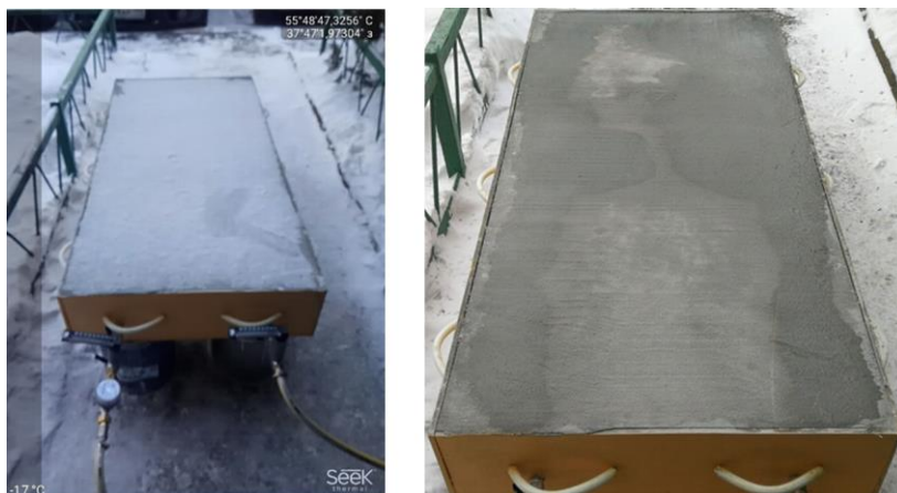
Рисунок 4. Вид экспериментальной модели одежды ездового полотна до и после выполнения исследовательского эксперимента с имитацией обледенения (фотография авторов)
