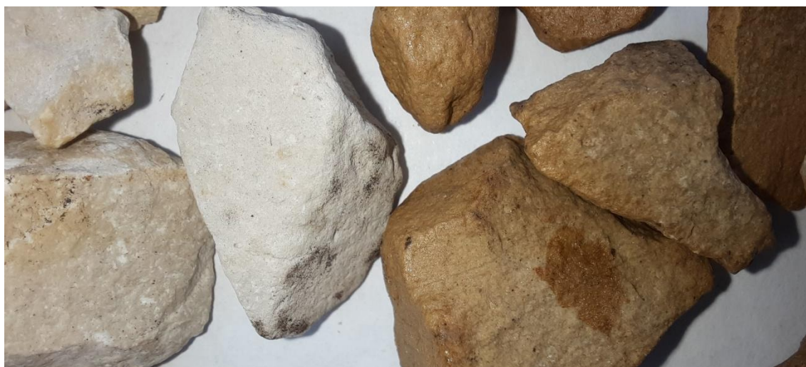
Рисунок 1. Зерна щебня до обработки (слева), зерна щебня после обработки раствором лигносульфоната (справа) (фото автора)
