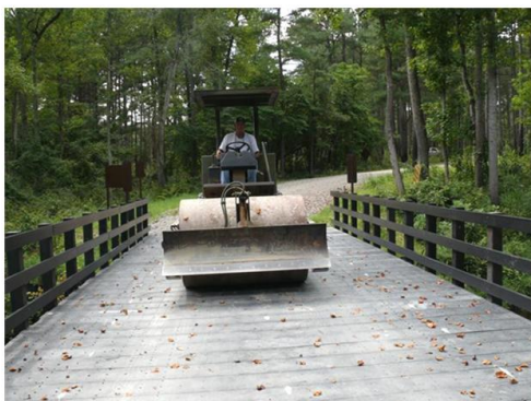
Рисунок 15. Успешный переход 30-тонного катка через мост T85-19 в Форт-Брэгге, Северная Каролина
