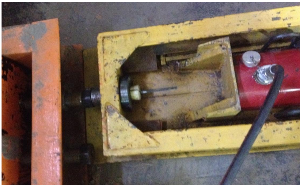
Рисунок 4. Установка натяжения (фото авторов) Figure 4. Tension installation (photo of authors)
