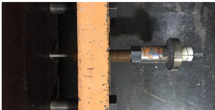
Рисунок 9. Анкеровка арматуры после натяжения (фото авторов) Figure 9. Anchoring of reinforcement after tension (photo of authors)
