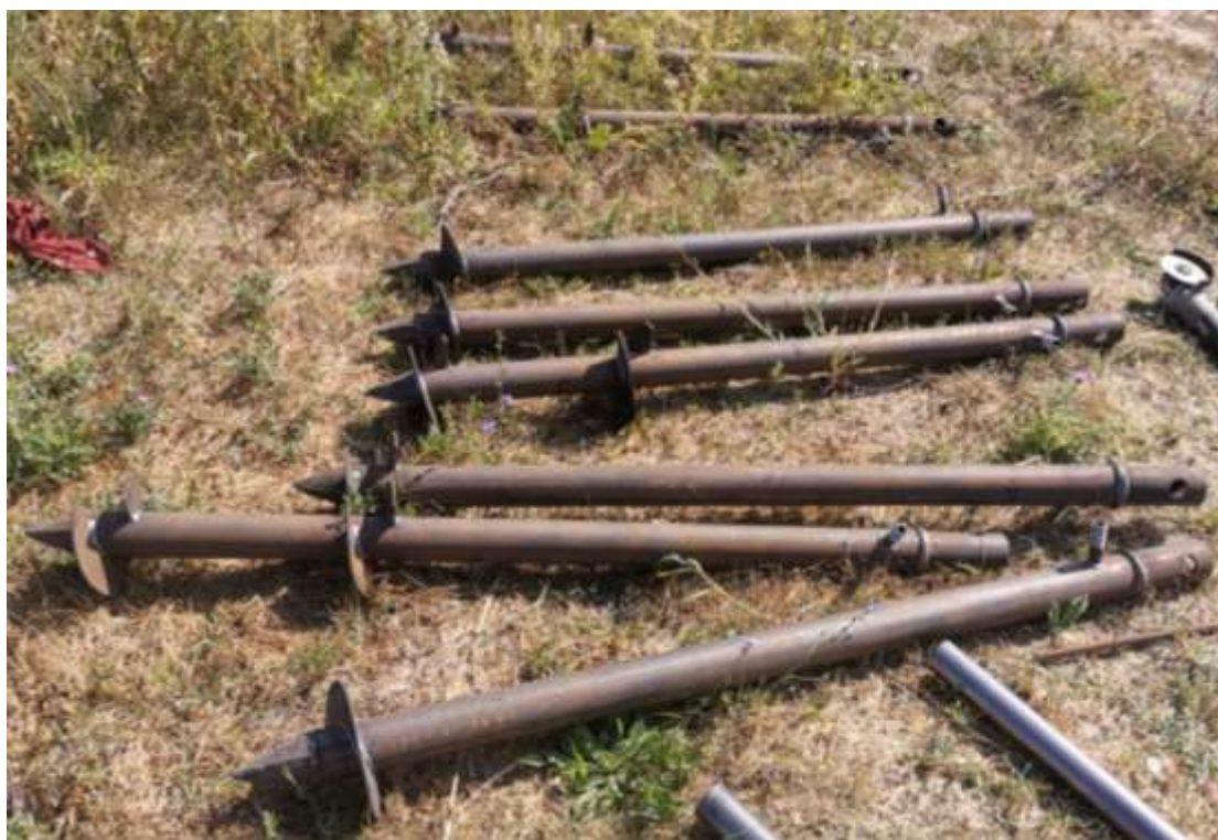
Рисунок 3. Общий вид опытных винтовых свай (фото автора)
