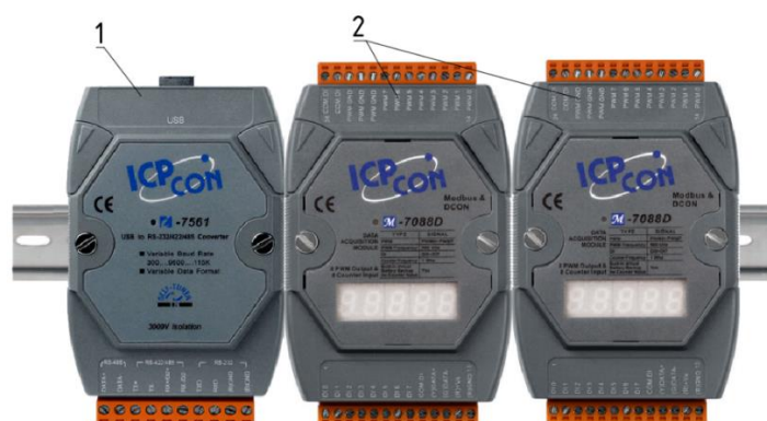
1 — конвертер ICP DAS I-7561; 2 — модуль вывода ICP DAS I-7080D
