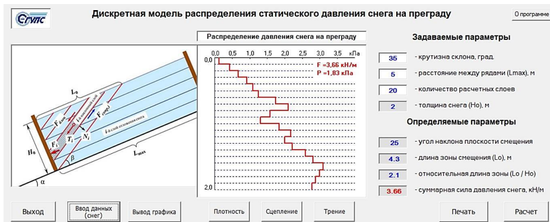
Рисунок 5. Расчет распределения давления снега на преграду (разработано авторами)
