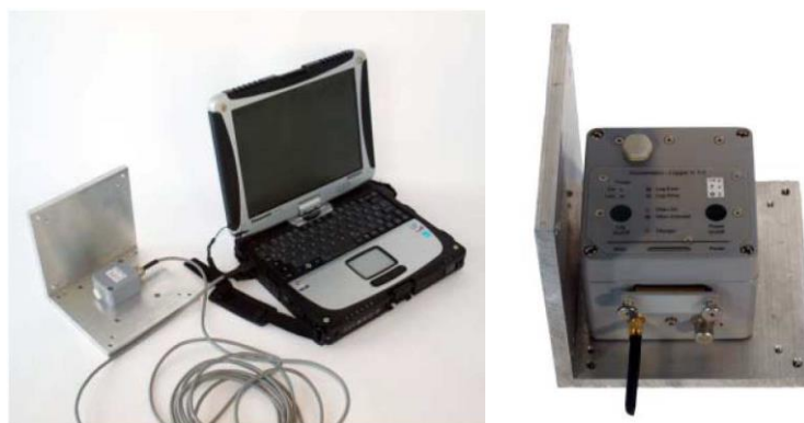
Рисунок 2. Датчик ускорения USB с ноутбуком (слева) и датчик ускорения беспроводной локальной сети (справа) [27]
