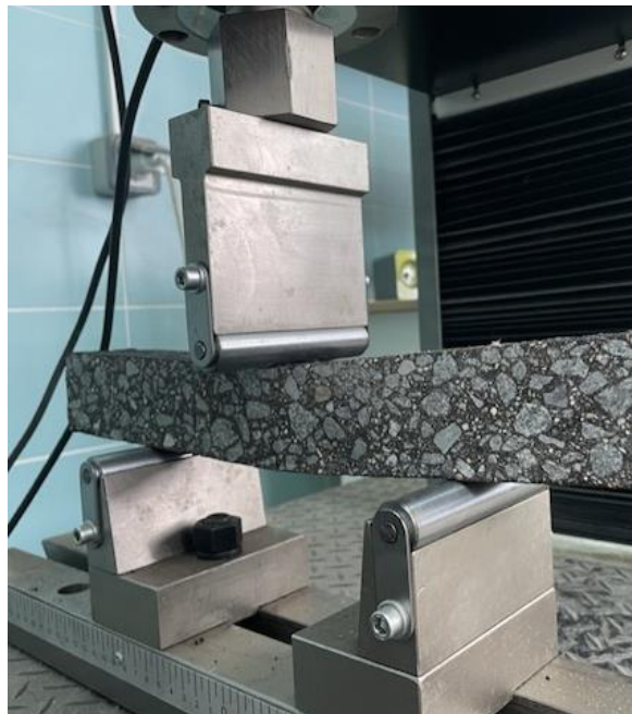
Рисунок 6. Процесс проведения лабораторного испытания по определению расчетных характеристик асфальтобетона на испытательной машине РЭМ-100-А (фото авторов)
