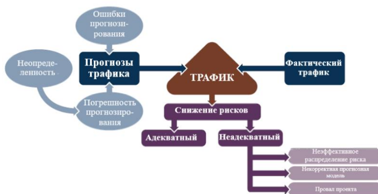
Рисунок 2. Влияние точности прогнозирования трафика на реализацию проекта по строительству дороги (составлен автором)
