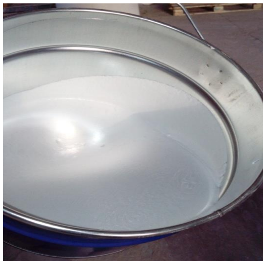
Рисунок 5. Заполнение тарного места расплавом термопласта (фото автора)
