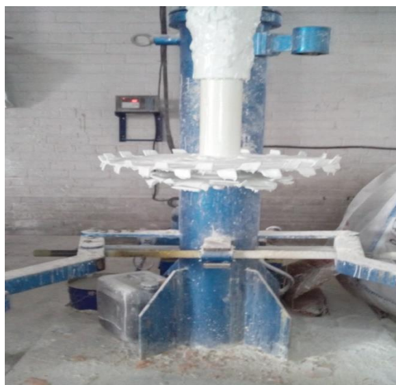
Рисунок 3. Рабочий орган смесительной установки (фото автора)
