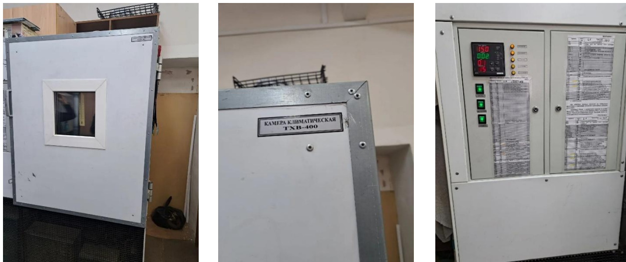
Рисунок 9. Камера климатическая ТХВ-400 (фото автора Вальцевой Т. Ю.)
