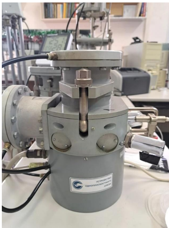
Рисунок 4. Устройство одноплоскостного среза (фото автора Вальцевой Т. Ю.)
