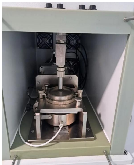
Рисунок 13. Устройство одноплоскостного среза (фото автора Вальцевой Т. Ю.)
