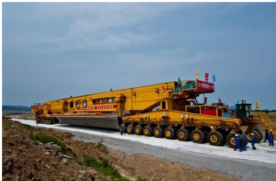
Рисунок 8. Мостоукладчик SLJ900/32 в транспортном состоянии (источник: https://www.techeblog.com/sl900-32-is-the-massive-580-ton-machine-they-use-to-build-bridges-these-videos-show-how/ Автор: Jackson Chung)
