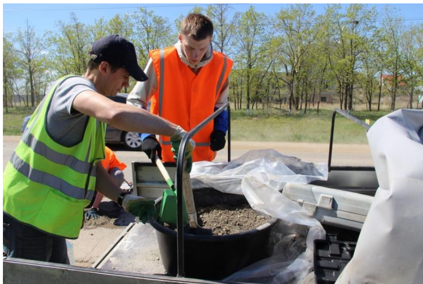
Рисунок 5. Отбор ремонтной смеси из емкости из кузова транспортного средства (фото авторов)
