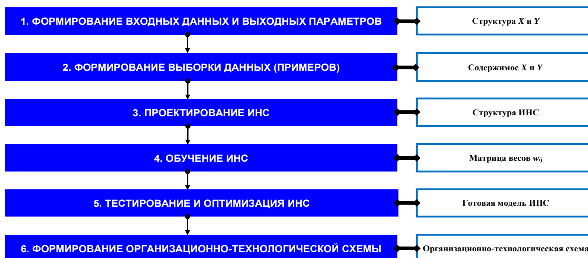
Рисунок 1. Схема математического моделирования искусственной нейронной сети для проектирования организационно-технологической схемы строительства объекта железнодорожного пути (разработано автором)
